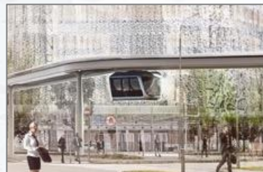
Mode aérien, peu d'emprise au sol, construction rapide
